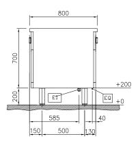
Electrical inlet (power) Equipotential screw
